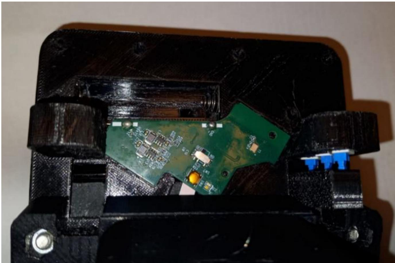
Una vez finalizada esta parte ponemos las tuercas en los orificios y lo fijamos con los tornillos de manera que las tuercas se queden colocadas en su sitio. Posteriormente tendremos que sacar los tornillos para poner la placa pero de esta manera aseguramos las tuercas en la posición correcta. Poner también las tuercas de la tapa de la pila ya que luego no se podrán poner.
