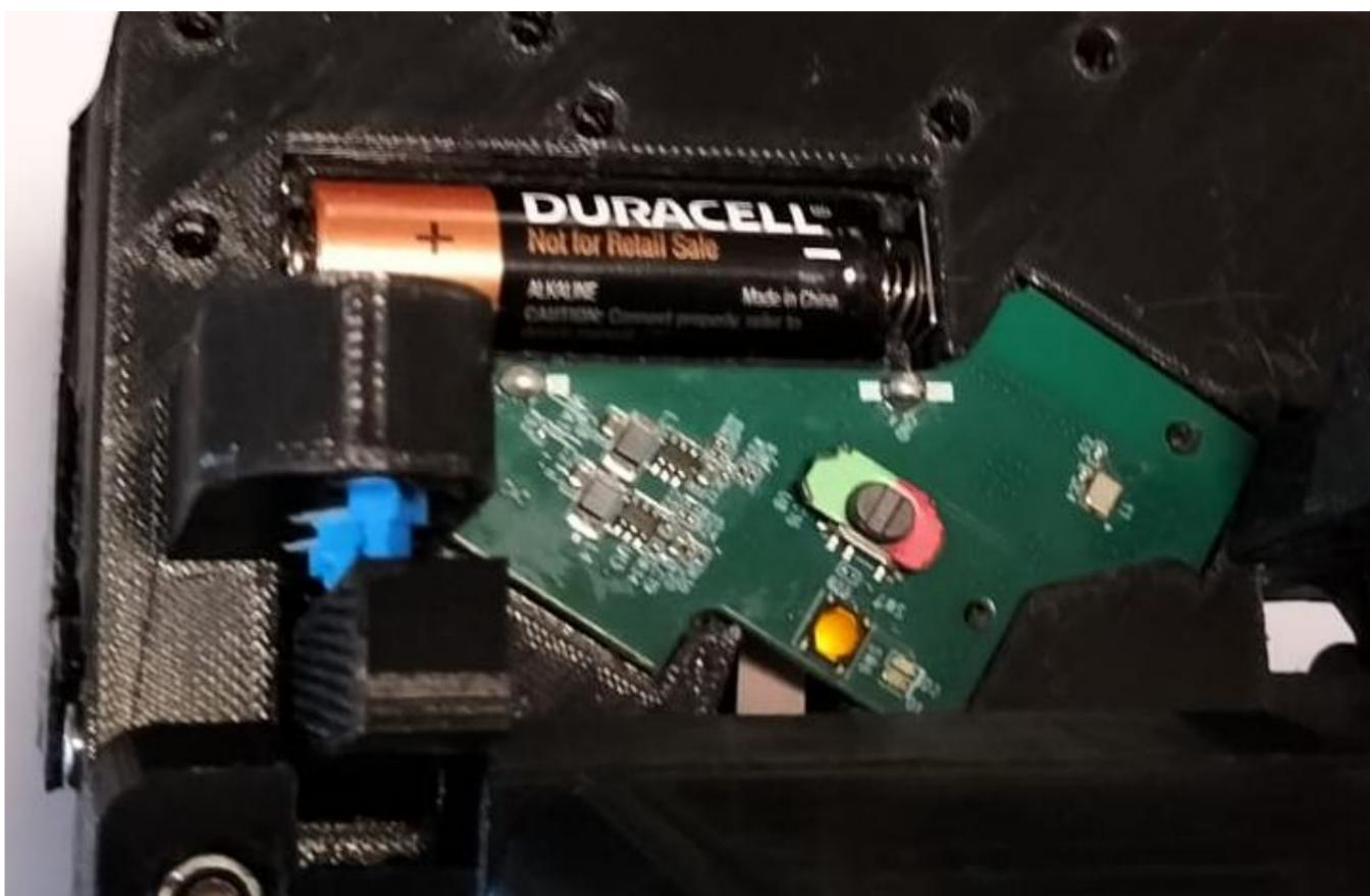
Colocamos todos los tornillos del conjunto, ponemos la tapa y la pila.
