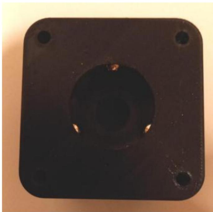
Para asegurar el ajuste de la bola al sistema se ha añadido un distancial en la parte inferior de 1mm. El distancial en la parte superior solo hay que ponerlo en caso de que la bola sobresalga demasiado por la parte superior (en nuestro diseño el distancial superior no lo montamos). Debemos hacer que la bola de goma sobresalga lo mínimo del orificio para impedir que los rodamientos de la electrónica se fuercen al apretar la bola con el pie.
